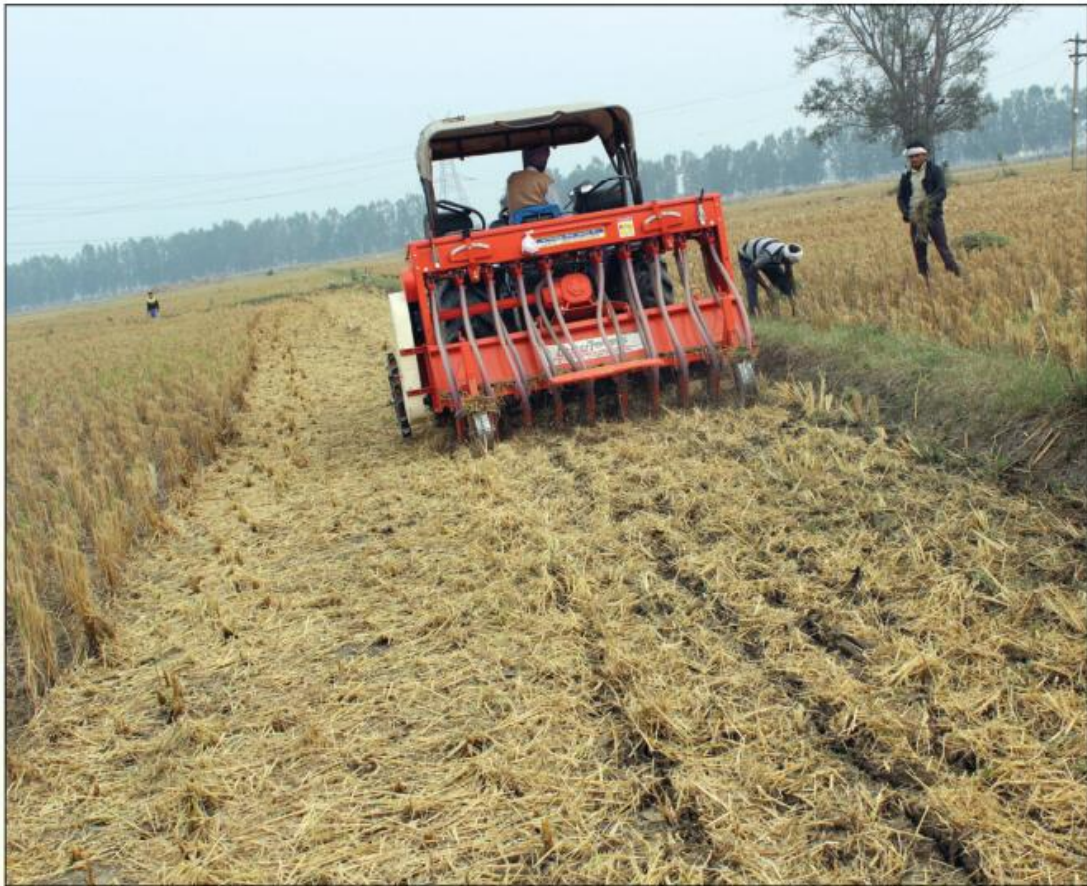
धान की फसल के डंठल को जलाये बिना गेहूं की बीजाई करते हुए
